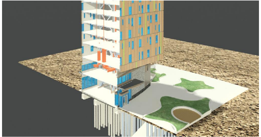
Каналы, анкерные сваи, глубокий фундамент из свай. Изображение принадлежит «Odeh Engineers».
